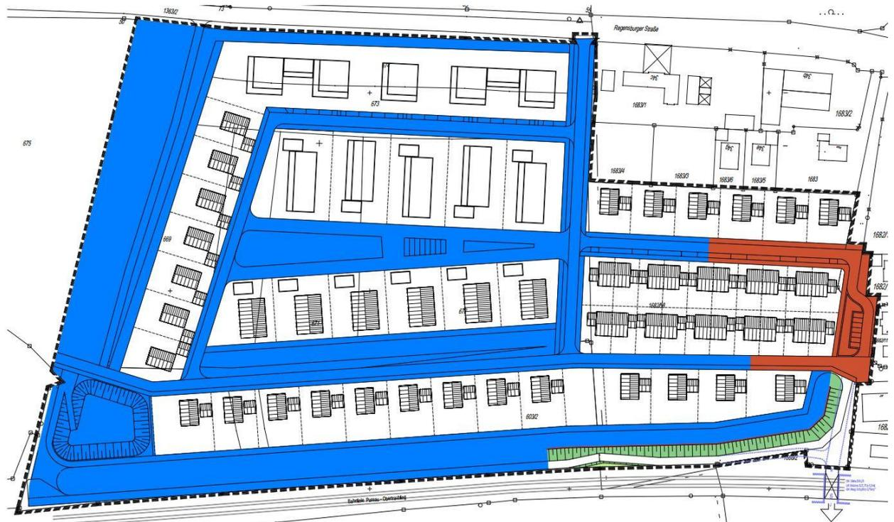
Abbildung 1: Einzugsgebiete der Überflutungsnachweise: Die blauen Flächen werden dem Sickerbecken zugeführt. Die roten Flächen werden in einer Rasenmulde zurückgehalten.
