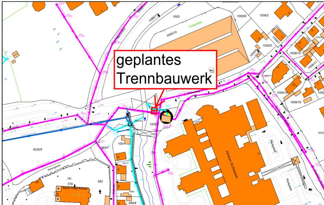
Abbildung 40: Trennbauwerk am PS Schanzlweg
