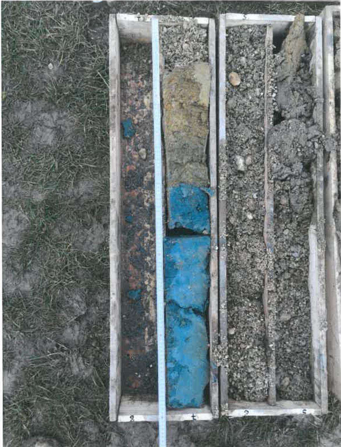
Foto 2: Darstellung der Bohrmeter 4 bis 7 m (unter Geländeoberkante)
