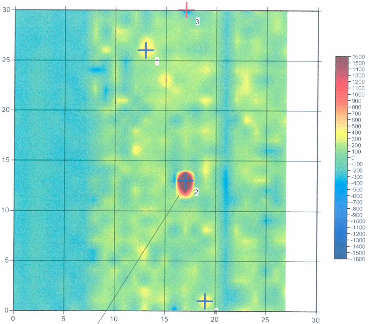
Eisenrohr einer Grundwassermessstelle oder ähnliches
