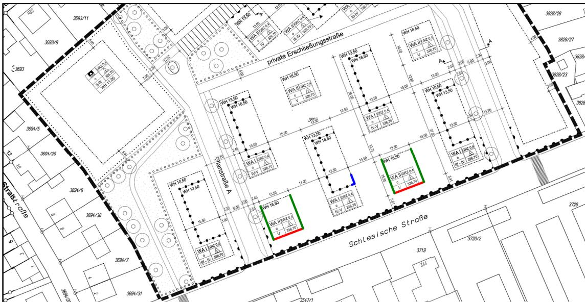
Abbildung 8: Kennzeichnung der erforderlichen Schallschutzmaßnahmen für Fassadenbereiche auf Höhe des vierten Obergeschosses
