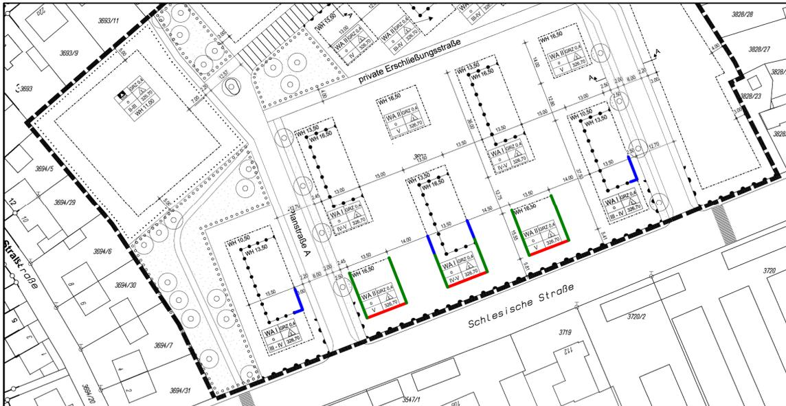
Abbildung 7: Kennzeichnung der erforderlichen Schallschutzmaßnahmen für Fassadenbereiche auf Höhe des dritten Obergeschosses
