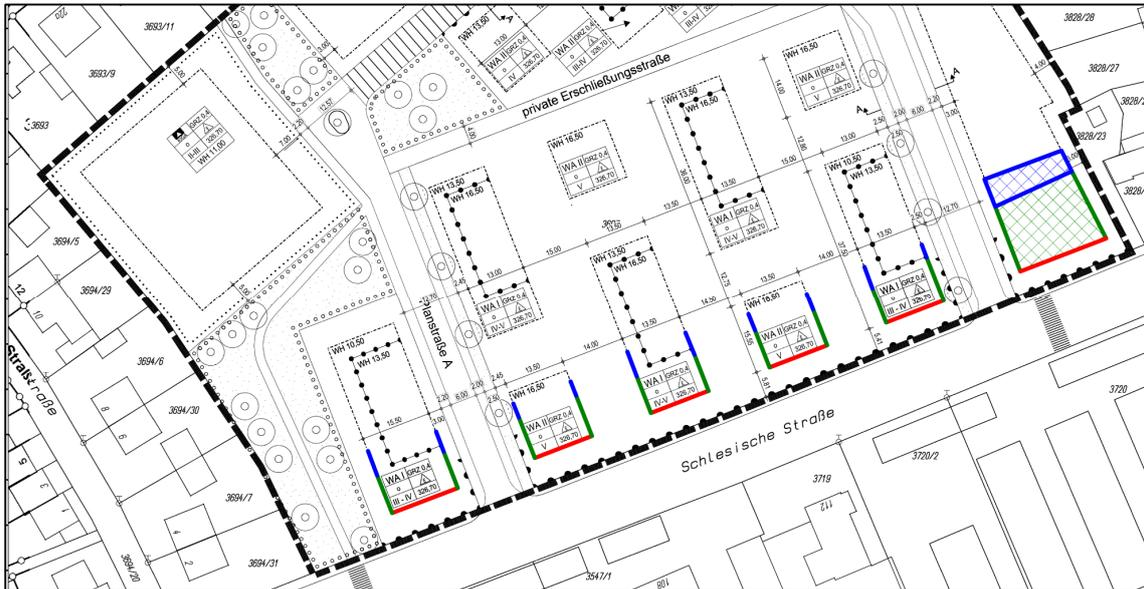
Abbildung 5: Kennzeichnung der erforderlichen Schallschutzmaßnahmen für Fassadenbereiche auf Höhe des Erdgeschosses
