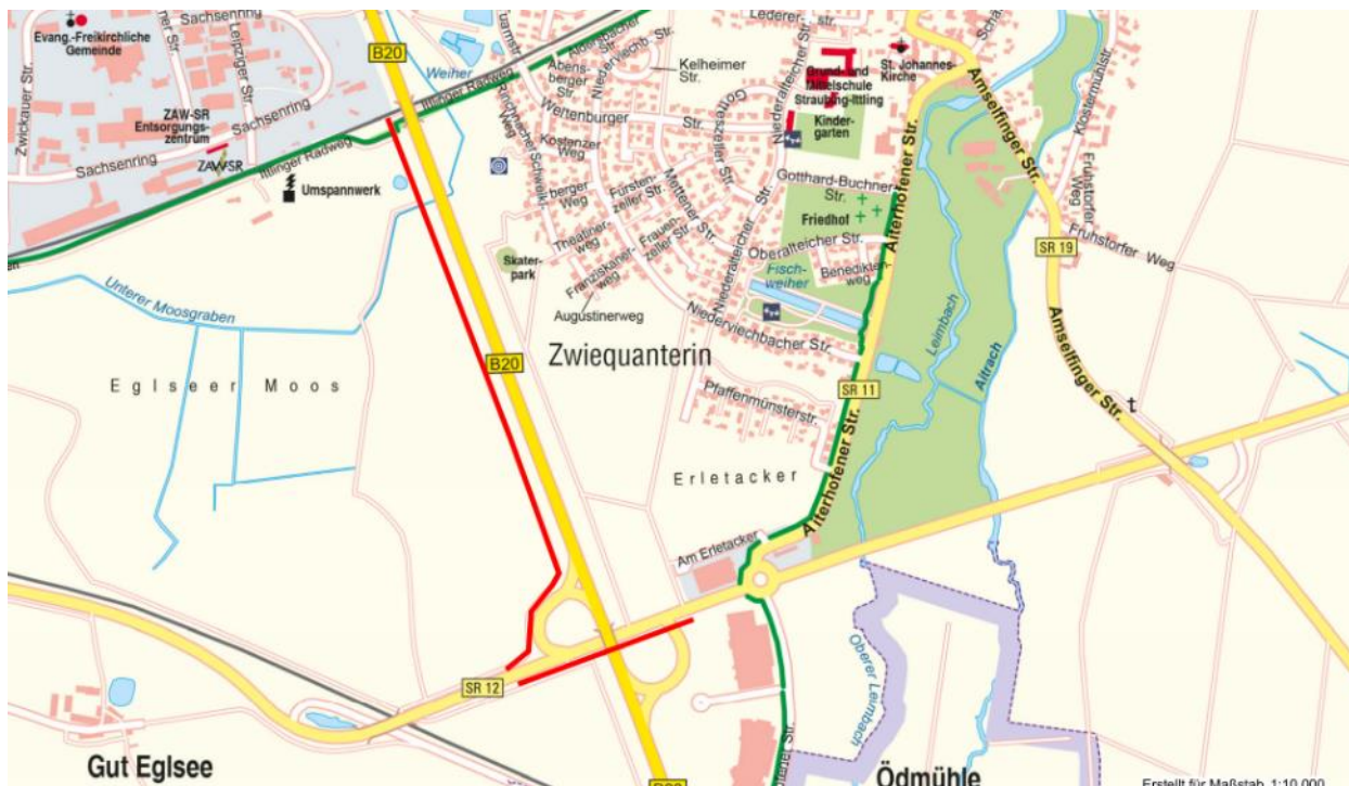
Abbildung 39: Vorabzug / Skizze geplante Radwegeverbindung (Darstellung rot) entlang B20 mit Anschluss an das Gebiet GE und SO Erletacker. Der Anschluss an das Gebiet Erletacker wird derzeit vom Tiefbauamt untersucht, ggf. soll er auf der Nordseite des Südrings verlaufen.– ohne Maßstab (Stadt Straubing)
