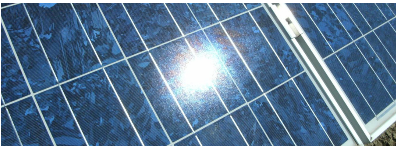
Bild 3.2.2: Diffuse Reflexion von direktem Sonnenlicht (Einstrahlung ca. 980 W/m 2 ) auf einem PV Modul (Quelle: SolPEG)
